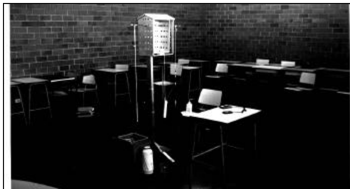
Figura 3.9- Conjunto para a Medição Hígro-Térmica e do vento
