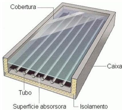
Figura 22 - Esquema de um coletor plano [16]
