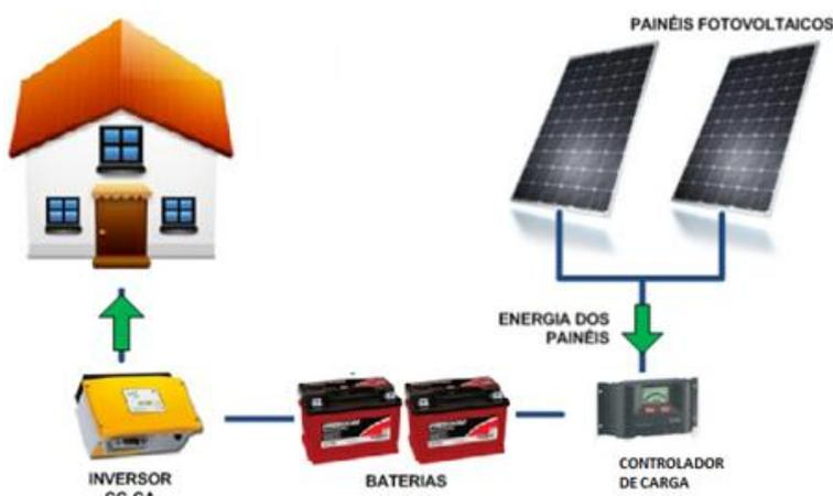
**Figura 5** - sistema solar fotovoltaico isolado.
