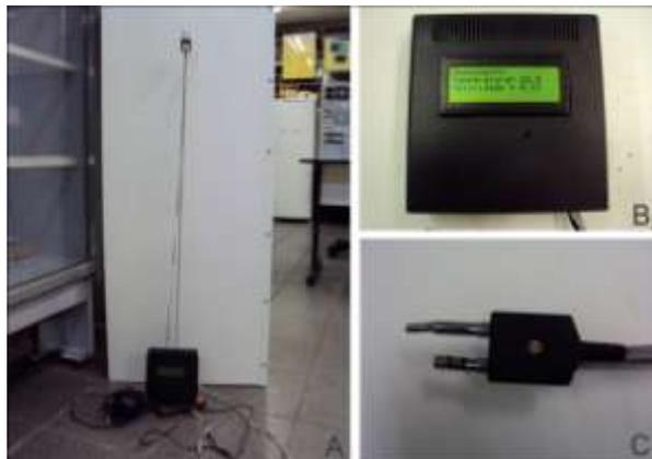
Figura 3.7 – A) Termo-anemômetro portátil utilizado no experimento, B) Detalhe do visor, C) Detalhe dos sensores de temperatura e velocidade do ar.
