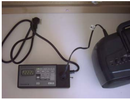
Figura 4 – Yokogawa e aparelho devidamente conectados, prontos para começar o ensaio.
