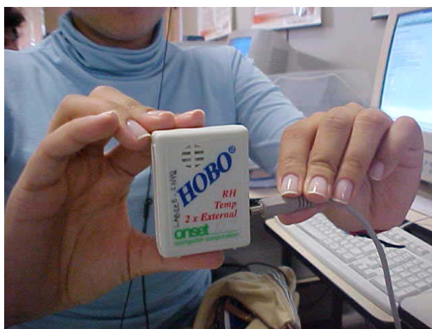
Figura 2 - Esquema conexão do cabo ao data logger.
