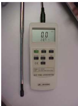
Figura 8. Tela de exibição com os valores da velocidade do ar zerados.
