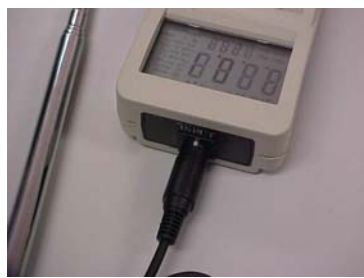
Figura 5. Conexão plug do fio da haste ao aparelho.
