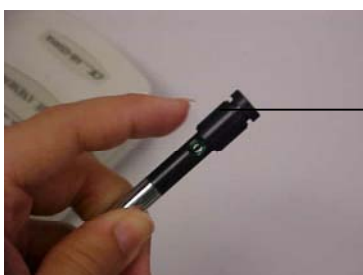
Figura 7. Sensores de velocidade do ar isolado do ambiente pela peça de cobertura.
