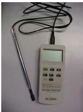
Figura 4. Conexão plug do fio da haste ao aparelho.
