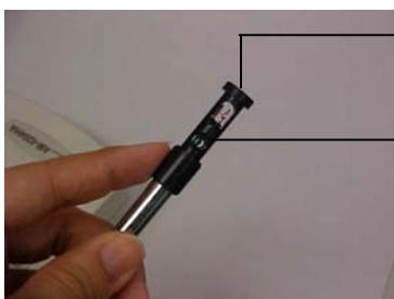
Figura 6. Sensores de velocidade do ar e temperatura do ar (Ponta da Haste).
