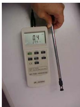
Figura 10. Aparelho medindo a velocidade do ar.
