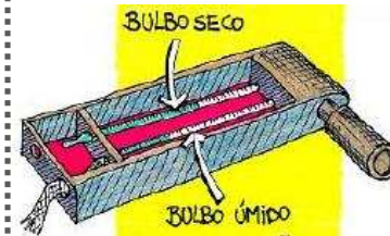
Psicrômetro giratório para medição de TBS e TBU
