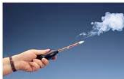
Figura 5 - Smoke sticks para a visualização do fluxo de ar predominante no interior dos ambientes.
